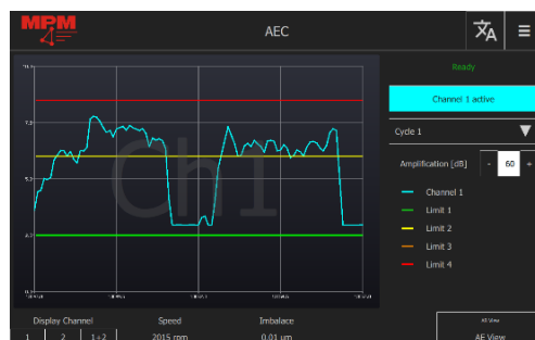
Beispiel: Schleifscheiben Abrichten
